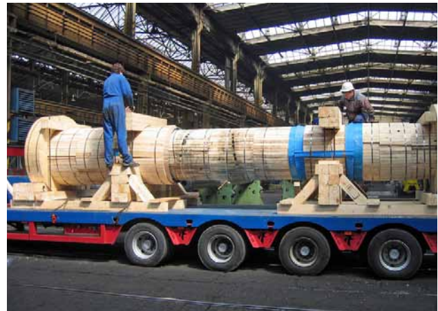
Der Maßanzug ist fertig. Holzpackmittel werden individuell auf das zu verpackende Produkt und unter Berücksichtigung des Transportweges entwickelt. Foto: HPE
